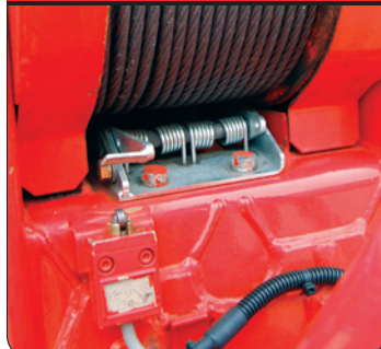
Snímač odmotání lana na bubnu
