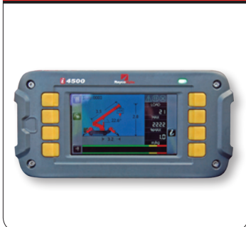
Měnitelné omezení rádius a výšky
