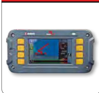
Měnitelné vymezení rádiusu a výšky
