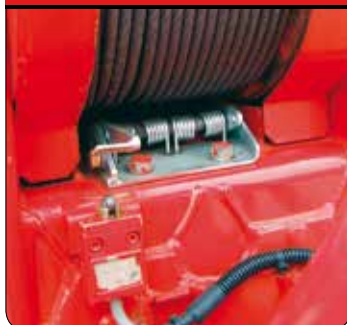
Snímač odmotání lana na bubnu
