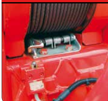
Snímač odmotání lana na bubnu
