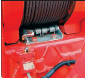
Snímač odmotání lana na bubnu
