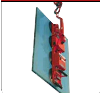
Vakuová přísavka na 1000kg
