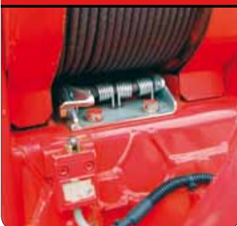
Snímač odmotání lana na bubnu
