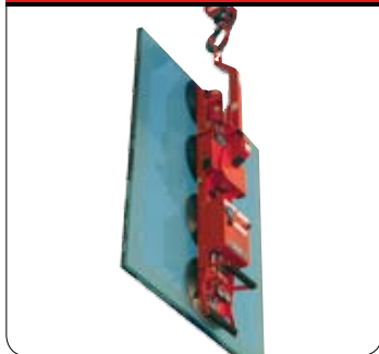
Vakuová přísavka na 1000kg
