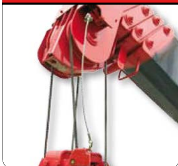
Snímač převrnutí háku
