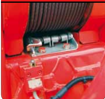
Snímač odmotání lana na bubnu
