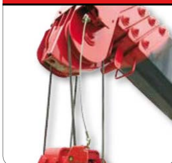
Snímač převrnutí háku
