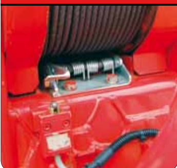
Snímač odmotání lana na bubnu
